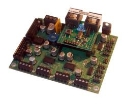
Diese neue Hardware ist eine Abwandlung der bekannten **OneControl Baugruppe** aus der OneSerie. Die Erneuerung ist, dass diese Baugruppe mit Hilfe eines Motortreibers in der Lage ist, acht Motorantriebe zubewegen. Mit dieser Baugruppe könnte man motorische Weichen, Hoffmann-Antriebe oder die bekannten Conrad-Antriebe ansteuern.
