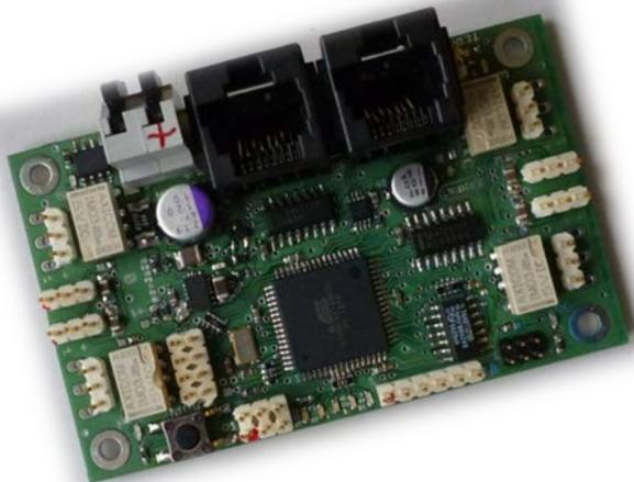
... ausgehend vom bekannten Alleskönner **OneST** und einer Diskussion im OpenDCC-Forum, entstand der Bedarf nach einer einfacheren und preiswerteren Hardware für „only“ Servo-Ports. **Die ST4 ist aus der Verschmelzung von BiDiBOne und dem OneST geboren und wird es nur als SMD vorbestückte Baugruppe geben.**
