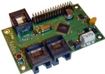
Wer seine Modellanlage computergesteuert über eine PC-Software steuert, benötigt für die Positionserkennung von Zug bzw. dem Fahrzeug auf der Straße eine Rückmeldung. Neben den Gleisbesetzmeldern mit dem Stromfühlerkonzept (z.B. GBM16T), gibt es auch Punktmelder die nur einen aktuellen Zustand an das PC-System melden. An diese Melder werden Hallensensoren (Magnetsensoren), Taster oder Reedkontakte angeschlossen um einen Durchfahrtsmelder, Positionsmeder oder einen Achsenzähler abzubilden.
