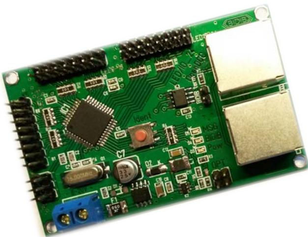
... eine weitere Baugruppe für LED-Ausgänge wird die neue **LED\_IO\_24** werden, die dem bestehenden Löt-Bausatz des MoBaLiSt sehr ähnlich kommt.
