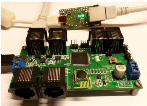
Mit der neuen Modellbahnsaison 2016 gibt es eine Erweiterung zum OpenCarSystem für die BiDiB-Integration. Das neue Interface stellt eine bidirektionale Verbindung zwischen dem BiDiB-Bussystem und dem fahrenden Fahrzeug mit OpenCar-Decodern her. (alle vorhandenen OpenCar-Decoder können nach einem Firmware-Update weiterverwendet werden, es ist keine neue und zusätzliche Hardware im Fahrzeug notwendig).
