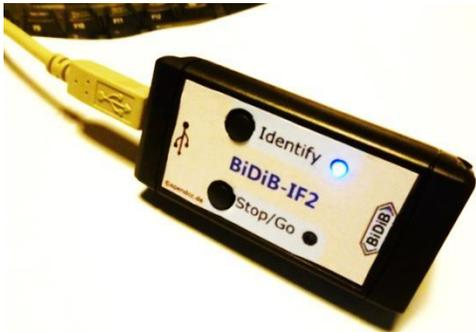
Die BiDiB-Entwickler arbeiten gerne unterwegs mit dem Laptop - und da war die Mitnahme eines kompletten GBMBoost samt Netzteil immer ein bisschen störend. Es entstand die Idee, ein kleines Interface in Form eines Sticks zu bauen. Der erste Versuch hierzu war ein radikal reduzierter GBMBoost. Das war soweit okay, allerdings fehlte ein passendes Gehäuse. Abgeleitet daraus um mit Blick auf ein schönes Gehäuse entstand dann das **BiDiB-IF<sub>2</sub>**.
