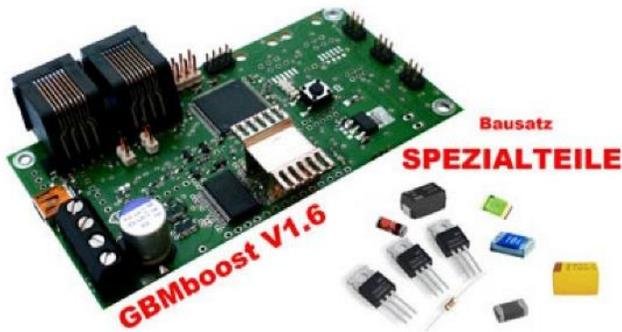
Mit Hilfe eines Anwenders und zahlreiche Temperaturtests in unserem Labor, haben wir einen Designfehler im Einsatz mit dem 3V<sub>3</sub> Linearregler vom Löt-Bausatz (Reichelt-Warenkorb) aufgespürt.
