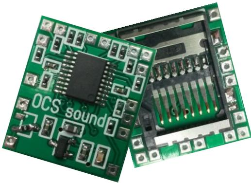
Mit dem OCS-Sounddecoder bekommt der CarDecoder V3 ein Erweiterungsmodul. Mit der zusätzlichen Extension-Platine stehen weitere LED Lichtausgänge zur Verfügung und über den Funktionstasten können bis zu 127 verschiedene Fahrzeuggeräusche von der MicroSD Karte wiedergegeben werden.
