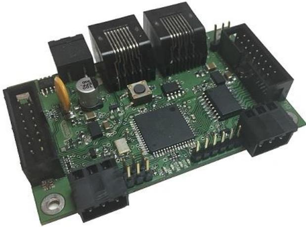
... BiDiB-Knoten mit dem Schwerpunkt „Beleuchten“ mit LEDs.
