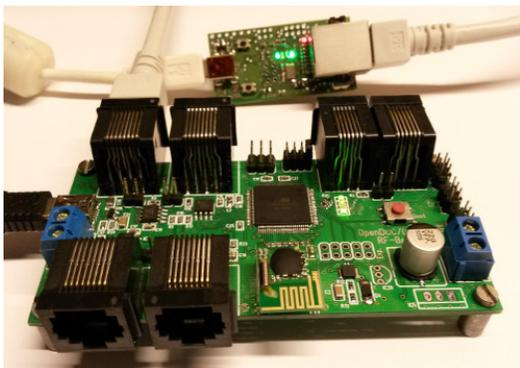
Mit der neuen Modellbahnsaison 2016 gibt es eine Erweiterung zum OpenCarSystem für die BiDiB-Integration. Das neue Interface stellt eine bidirektionale Verbindung zwischen dem BiDiB-Bussystem und dem fahrenden Fahrzeug mit OpenCar-Decodern her. (alle vorhandenen OpenCar-Decoder können nach einem Firmware-Update weiterverwendet werden, es ist keine neue und zusätzliche Hardware im Fahrzeug notwendig).
