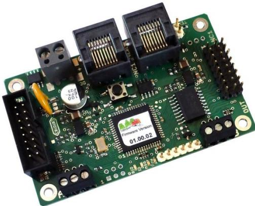
Unter der Verwendung von LEDs des Typs WS2812 oder mit externen Chips des Typs WS2811, kann ohne großen Verkabelungsaufwand, komplexe Lichtszenarien (z.B. Kirmes, mehrbegriffige Lichtsignale oder flexible Hausbeleuchtungen) mit der neuen Baugruppe „NeoControl“ realisiert werden.
