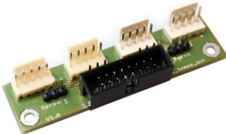
Mit dem Gegenstück **LCsensorOUT** kann das bewährte Platinchen „LCsensor“, noch einfacher mit den BiDiB-Baugruppen verbunden werden. Diese Zusatzplatine "**LCsensorOUT**" ist eine Verbindungsplatine zum Verbinden von mehreren LCSensor-Platinen mit einer BiDiB-Baugruppe.
