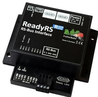
Ready, also fertig ist das Motto der neuen ReadyLine. Mit der ReadyRS kommt von FichtelBahn eine Baugruppe, die ohne Lötarbeit und mit einem schicken Gehäuse vom Anwender eingesetzt werden kann. Mit dieser Baugruppe können vorhandene RS-Melder z.B. von der Firma Lenz Elektronik, an das BiDiB-System angeschlossen werden. Bestehende Anlagen können somit BiDiB tauglich gemacht werden, ohne dass bestehende Technik entsorgt werden muss.
