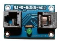
Wieder ist ein kleiner Löt-Bausatz aus einer Diskussion im OpenDCC-Forum entstanden. Mit Hilfe dieser kleinen Lötaufgabe (4 Bauteile), kann der BiDiBus bei Modulübergängen getrennt werden.
