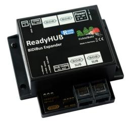
Der BiDiBus ist nach einer Baumstruktur aufgebaut und dessen Verbindung zum PC übernimmt ein Interface z.B. BiDiB-IF2 oder GBMboost Master / GBM Master.
