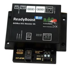
Mit dem ReadyBoost gibt es ein vollständiges Fertigbaustein-Gespann für die Bereiche "Fahren und Melden". Der ReadyBoost liefert einen dauerhaften Ausgangsstrom von 4A Strom und kann kurzfristig einen Peakstrom bis 5A bereitstellen. Die kurzfristige Leistungsreserve von über 4A sollte den 2-stelligen Sekundenbereich nicht überschreiten.
