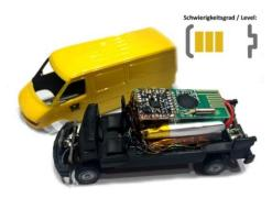
Ein Standmodell umzurüsten mit allen sinnvollen Funktionen vom Blinker bis zu den Front- und Rückleuchten ist nicht gerade sehr einfach, wenn man Schwierigkeiten bei den kleinen SMD-Leuchtdioden hat.
