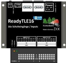
ReadyTLE mit 16 Eingänge ist ein Fertigbaustein für das OpenCar-System, geeignet für TLE-Sensoren und für die Rückmeldung der Belegzustände vom FeedCar Modul.
