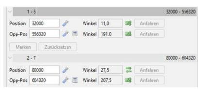
Neben dem Erlernen des Abgangs im BiDiB-Wizard teilt man der Baugruppe mit Hilfe der grünen Pfeile auch die korrekte Gleispolarität mit, so dass bei der Abfahrt von der Bühne die Relais korrekt geschaltet werden und eine Überfahrt ohne Kurzschluss erfolgt.
