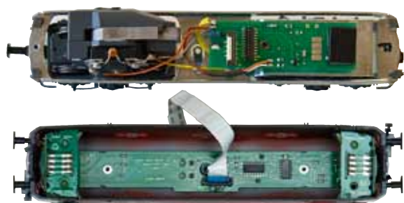
SBB Re 420 «Lion» Elektronik Umbausatz
