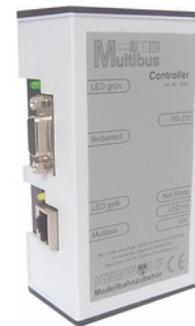
Bis zu 16 Fahrregler SFR2000 lassen sich mittels der Option Multibus in das Multibus-System integrieren. Der Multibus-Controller verwaltet zentral alle Fahrzeugeinstellungen und die Belegung von bis zu 255 Gleisabschnitten. Für das Übergeben von Fahrzeugen von einem Stromkreis in einen anderen können die Fahrregler per Knopfdruck aneinander gekoppelt werden.
