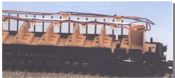
2783 Erweiterung zur Innenbeleuchtung 2781/82. Zum Beleuchten von zusätzlichen Abteilen oder des Ganges von Abteilwagen. Bestehend aus 3 Einzel-LED, zum Anlöten an 2781 bzw. 2782. An eine Innenbeleuchtung können maximal 18 einzelne LED angeschlossen werden. Länge mit Anschlusskabel ca 150 mm. Stromaufnahme ca. 15 mA.
