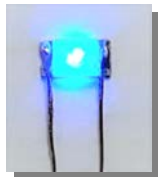
2744 Micro LED blau mit zwei angelöteten CU Drähten. Zum Betrieb wird ein Vorwiderstand 2761 benötigt Maße: 3,2 x 1,5 x 1,3
