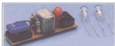
2673 Konstant-Zugbeleuchtung für Wechselstrombahnen , hält die Zugbeleuchtung ab einer Fahrspannung von ca. 4 Volt auf gleicher Helligkeit und verhindert das Aufblitzen beim Umschalten. Bis zu 3 Glühlampen anschließbar (max 105 mA). Mit 2 Glühlampen V, 35 mA. Maße: 37 x 9,5 x 10 mm
