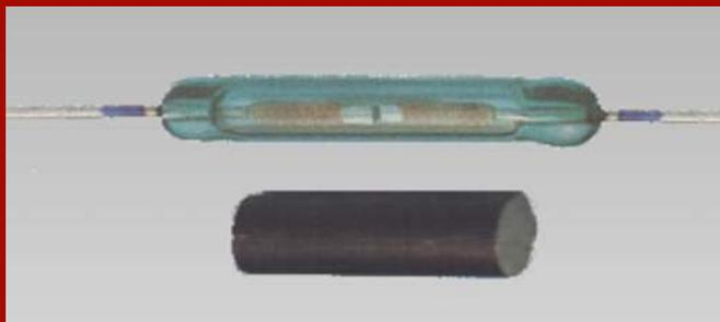
**Herkat Magnet-Schalt-System mit Schutzgas Rohr Kontakten (kurz SRK genannt)** werden mit Dauermagneten, die unter den Fahrzeugen angebracht werden, zum automatischen Schalten von Weichen und anderen Magnetartikeln verwendet.
