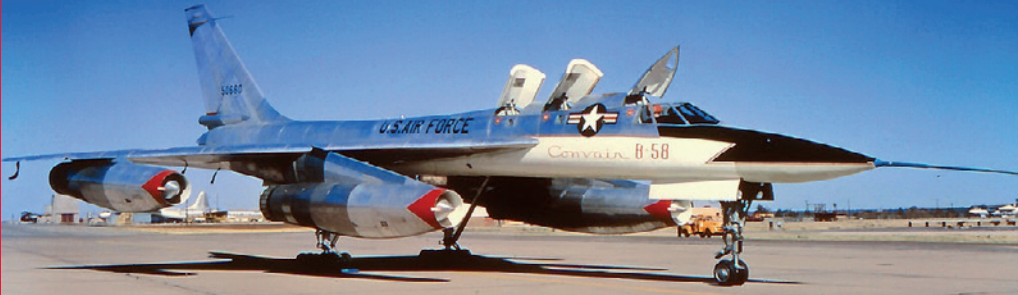
559850 U.S. Air Force Convair XB-58 Hustler – 55-0660 mit abnehmbarem Fahwerk / with removable landing gear.
