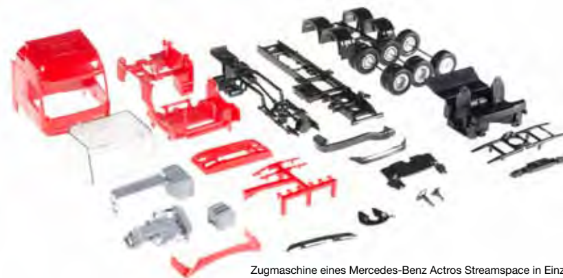
Zugmaschine eines Mercedes-Benz Actros Streamspace in Einzelteilen. Individual components of a Mercedes-Benz Actros Streamspace rigid tractor.
