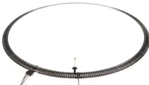
Collegare un sensore di rilevazione delle locomotive a una sezione del plastico.
