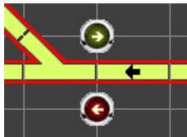
Come si può notare, i tasti degli scambi sono stati posizionati nel punto di intersezione della griglia. Adottando questa regola generale, la progettazione del tracciato risulta ordinata e semplice da seguire. Nel momento in cui si fa funzionare il plastico, la posizione impostata si illumina e non occorre fare altro che fare clic sul tasto dello scambio per attivarlo. Per controllare un incrocio come quello riportato nell'esempio seguente:
