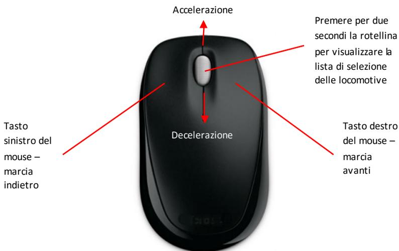
A questo punto è possibile utilizzare il tasto sinistro del mouse per comandare la marcia indietro della locomotiva e quello destro per controllare la marcia avanti. Muovendo la rotellina del mouse verso l'alto è possibile aumentare la velocità di marcia o diminuirla muovendo la rotellina verso il basso.
