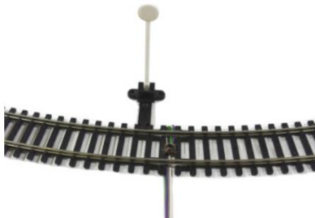
Aggiungere un piccola striscia riflettente nella parte inferiore della locomotiva, controllando che sia a una distanza compresa tra 1 e 4mm dal sensore. Se necessario, usare degli spessori autoadesivi per avvicinare la striscia al sensore.
