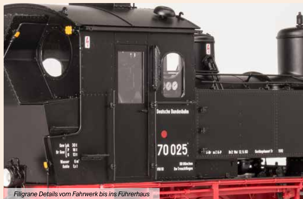
Zu öffnende Dachbelüftung und Sandkastendeckel
