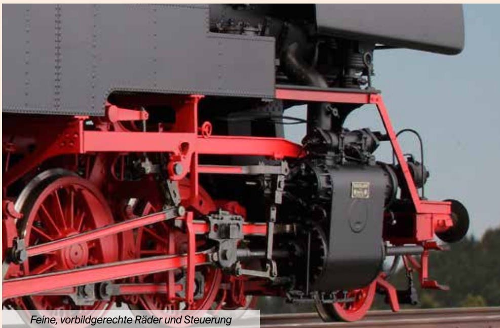
Das Drillingtriebwerk mit Details wie Schmierleitungen
