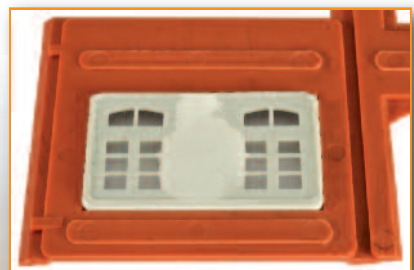
7. Die mit Scheiben versehenen Fenster sind nun aufnahmebereit für die Lichtboxen.
