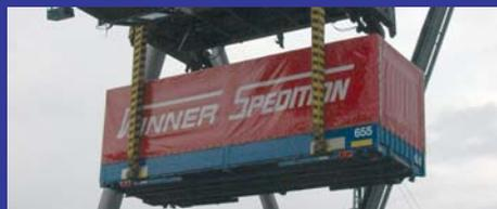
Der Umschlag findet mit Greifzangen statt. Auch bei WB gibt es je nach Transportgut verschiedene Bauarten: Pritsche/Plane, Koffer, Bulk, Silo, Tank. Europaweit sind über 350.000 Einheiten im Einsatz.
