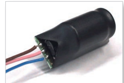
Digital plus USP-Speicher POWER 1 Art. Nr. 10490 Abmessungen ca. 22 x 13,3 x 9,4 mm
