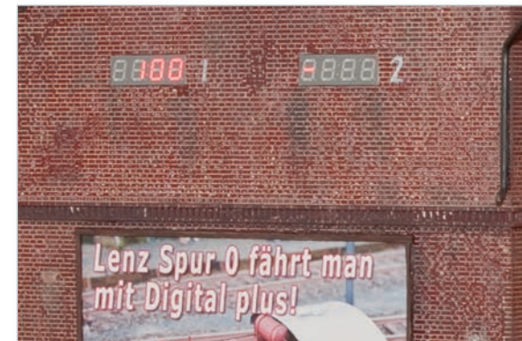
Adressanzeigen LRC120 in der Stirnwand unseres Bahnhofs Krakow
