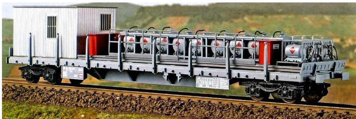
**ART. 1366 Carro pianale FS Rgs per rifornimento carburante delle macchine operatrici durante l'impiego nei cantieri Ep. IV – V**
