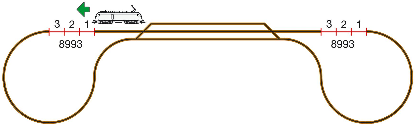
Lösung für den „Hundeknochen“: Durch den Einsatz zweier Kehrschleifengarnituren werden Kurzschlüsse im Bahnhof verhindert.
