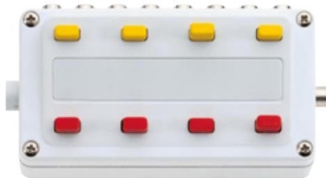
Schaltpult **Art. 72740** verteilt einen Bahn- oder Lichtstromkreis auf vier verschiedene Leitungen mit je zwei Anschlüssen. Somit können etwa vier Abstellgleise im gleichen Bahnstromkreis oder vier Verbraucher im gleichen Lichtstromkreis geschaltet werden. Das Schaltpult besitzt acht rückseitige und zwei seitliche Anschlussbuchsen.
