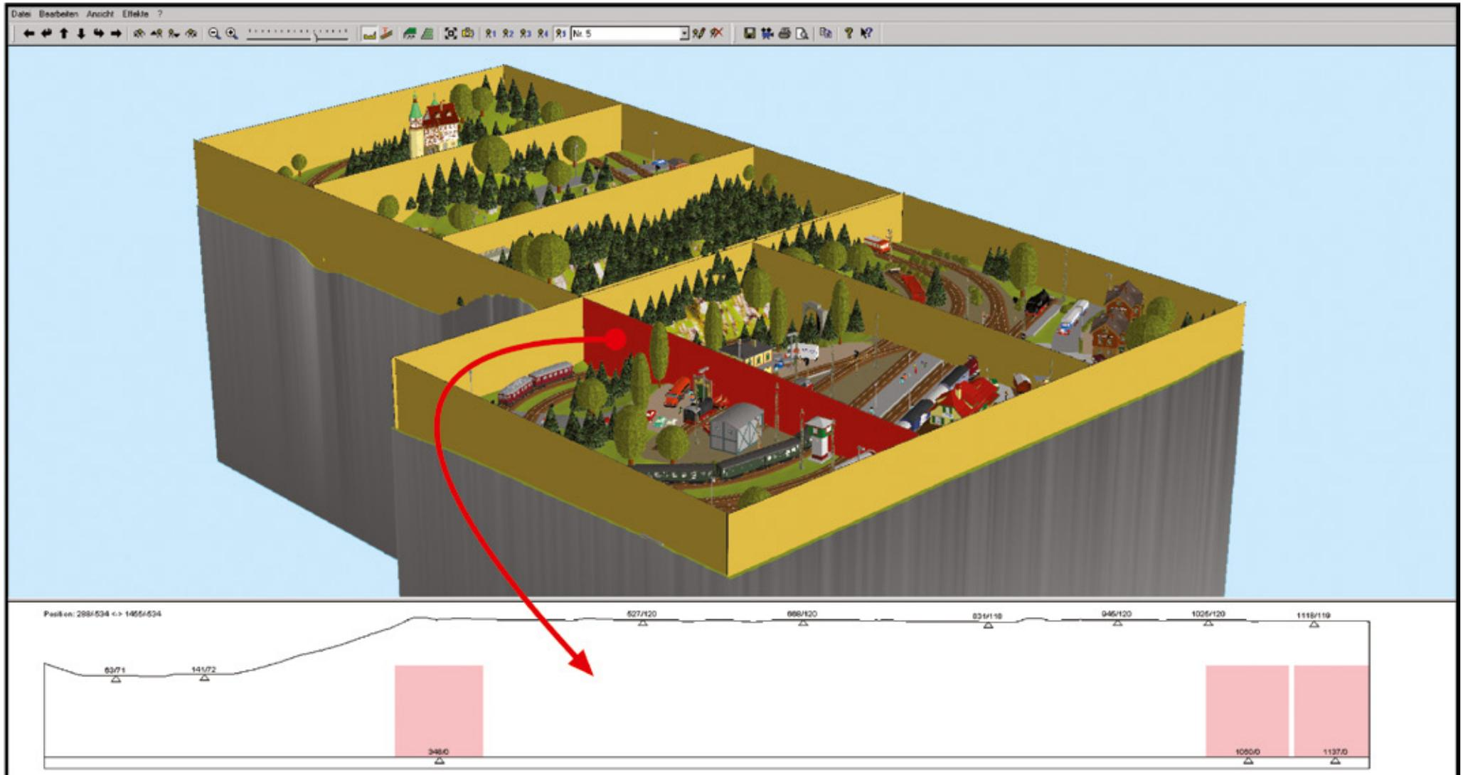
Die angegebenen Spanten sind in der Darstellung mit Wintrack bereits eingetragen. In der 3-D-Darstellung setzt man einen Mausclick auf die entsprechende Spante, und Wintrack stellt sie im unteren Drittel des Bildschirms dar. Mit Höhenangaben und Breitenentfernungen werden dann die Maße auf die Originalspante übertragen und ausgeschnitten. Die farbigen Felder sind die Aussparungen für den Schattenbahnhof.
