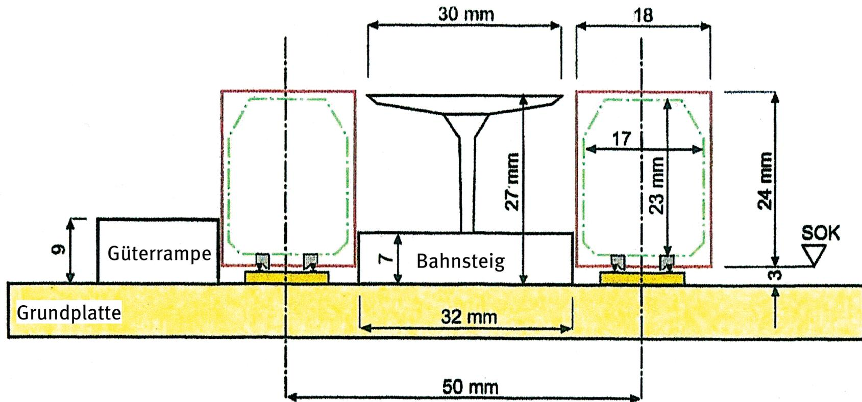
Die Einbaumaße für überdachte Bahnsteig und Güterrampe an geraden Gleisen ergeben sich nach den NEM 102 und 301. Die Skizze enthält alle zum Bahnsteig- und Rampeneinbau erforderlichen Maße.
