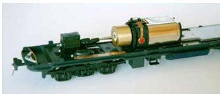
El esfuerzo de tracción está asegurado por la presencia de aros de adherencia en dos de las ruedas del bogie motor. Sustitúyalos cuando presenten síntomas de agotamiento.
