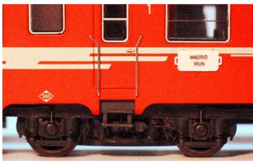
Estamos especialmente orgullosos de la fidelidad con la que hemos conseguido reproducir los bogies del tren. La calidad y ductilidad del plástico empleado hace que podamos apreciar a simple vista la suspensión primaria y secundaria, las cajas de grasa y las zapatas de freno (únicamente presentes en la versión más clásica, ya que en la versión rojo-gris fueron sustituidos por frenos de disco).
