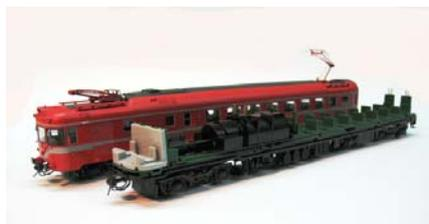
Nuestro modelo emplea un único bogie motor que asegura la tracción del tren. Se encuentra ubicado en el furgón del coche de 2da. clase y emplea una sencilla cascada de engranajes de nylon para minimizar la sonoridad y asegurar un rodaje suave.
