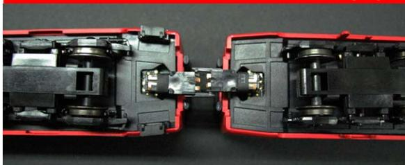
Es necesario enganchar todos vehículos con el conector eléctrico para que el tren funcione correctamente. Para realizar esta operación, recomendamos coloque los tres vehículos boca abajo y una vez ensamblados, colóquelos sobre la vía. Procure mantenerlas limpias, así como las ruedas de los vehículos, para asegurar un rodaje
