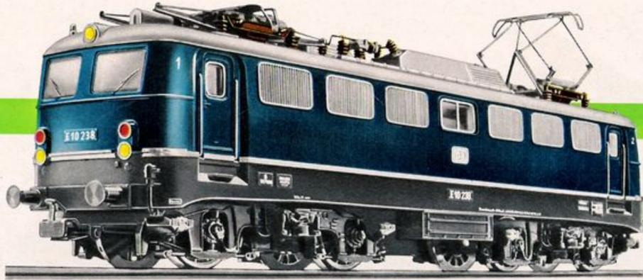
Il locomotore della categoria E 10 è stato adibito dalle Ferrovie Federali Germaniche, dopo l'anno 1956, su vasta scala al servizio pesante dei treni rapidi. Con i suoi 4 motori, della forza complessiva di 5000 CV, il locomotore raggiunge la velocità massima di 150 Km/h. ed una forza di trazione, in partenza, di 28 t. Il suo peso totale è di 85 t. Lunghezza fuori respingenti 16,44 m.
