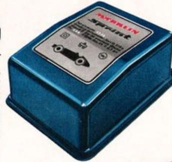
**Trasformatore a corrente continua MÄRKLIN-SPRINT**. Solo per corrente alternata 220 Volt. Resa 10 Watt. Uscita tensione continua 14 V. Protezione contro il sovraccarico di corrente tramite interruzione automatica di corrente. Custodia di lamiera di acciaio blu. Dal lato di uscita 2 coppie di bocche con la denominazione Auto 1 e Auto 2. Peso 1 Kg. Dimensioni 12,5 x 9,5 x 5,5 cm
