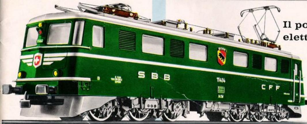
I locomotori Ae 6/6 trasportano soprattutto i treni rapidi ed i treni merci che transitano sulla linea del Gottardo e del Sempione. I sei motori di una capacità complessiva di 6000 CV fanno raggiungere al locomotore una velocità massima di 125 Km/h. Esso pesa 120 t.
