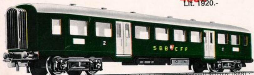
4038 Vettura per treno rapido leggero - 4 assi - Modello delle Ferrovie Federali Svizzere (SBB) - Carrelli con parti laterali mobili - Finestrini con cellofane - Soffietti di comunicazione - Verde, tetto grigio-argento - Lunghezza fuori respingenti 21 cm
