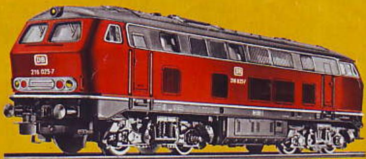
*Questi locomotori-Diesel della categoria 216 vengono impiegati per l'esercizio su percorsi medi. A pieno carico di carburante hanno un peso di servizio di 79 t. Con la potenza del motore di 1400 kW raggiungono una velocità massima di 120 Km/h.*
