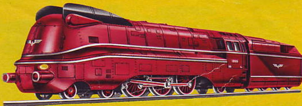
*Dopo prove su altre locomotive della linea aerodinamica, prove che hanno messo in evidenza una riduzione della resistenza dell'aria nella velocità, dal 1937 venne posta in servizio la serie 03<sup>10</sup> che fu però lasciata con il biellismo scoperto per facilitarne la manutenzione.*
