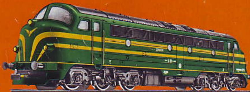
*Il locomotore-Diesel belga tipo 204 viene comandato elettricamente. Con i suoi 1300 kW di potenza è impiegato per treni merci leggeri ma anche per treni passeggeri e treni direttissimi e raggiunge una velocità massima di 140 Km/h.*
