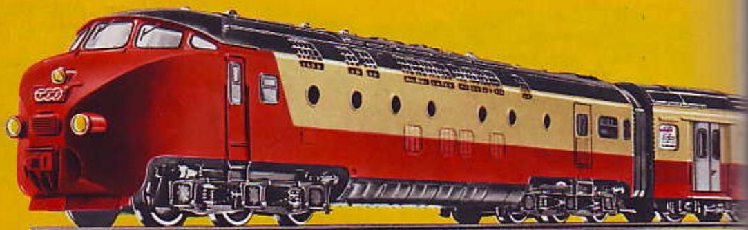
Speciali ganci uniscono strettamente fra loro le 3 unità · Particolari chiusure aderenti per i passaggi alle estremità delle vetture · Tre fanali a luce bianca riflessa e 2 fanalini rossi posteriori nella vettura motrice e pilota, con accensione automatica a seconda del senso di
