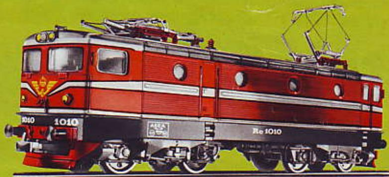
*In queste macchine costruite molto modernamente, la corrente alternata di frequenza 16 2/3 Hz viene raddrizzata in corrente continua mediante Thyristor ed inviata ai 4 motori. Questi motori svilup-*
