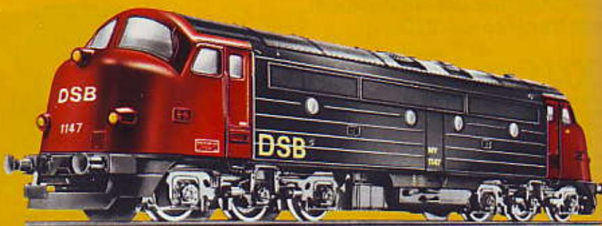
*Questo locomotore-Diesel ad uso vario, serie My 1100 delle Ferrovie Statali Danesi è azionato elettricamente. Cioè la corrente per l'azionamento degli assi-motori viene prodotta dai generatori*
