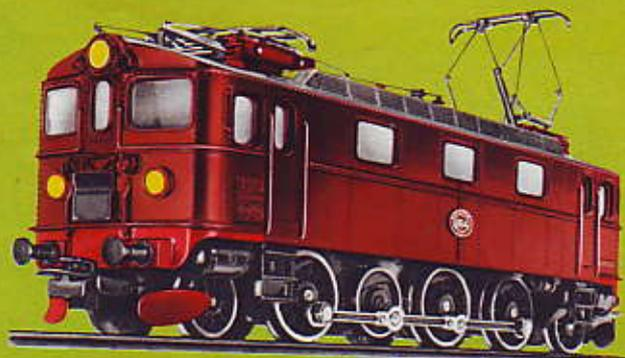
*Il tipo Da delle Ferrovie Statali Svedesi (Statens Järnvägar) viene impiegato quale elettro-locomotiva Standard per treni passeggeri e merci. Siccome queste motrici non comportano che un*
