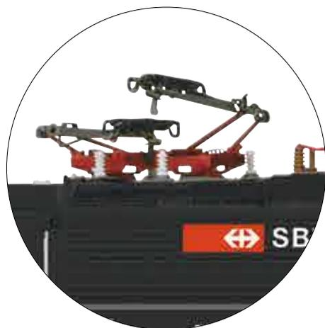
Con differenti pantografi per il traffico dei treni che oltrepassano i confini
