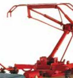
Pantografo di nuova progettazione del tipo SBS 65
