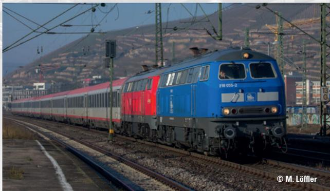
**Prototipo:** Locomotiva Diesel-idraulica del Gruppo 218 della Ferrovia della Pressnitztal S.r.l. (PRESS) in colorazione blu trasporti. Rodiggio Bo'Bo'. Condizioni di esercizio attuali.
