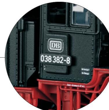
Con applicazione conforme all'epoca della cassetta Indusi al fianco destro della cabina di guida
