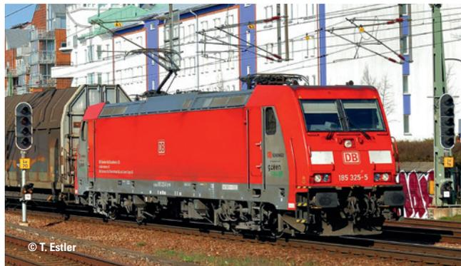
**Prototipo:** Locomotiva elettrica Traxx 2, tipo F 140 AC2 della ditta DB Schenker Rail Scandinavia A/S, una collaborazione tra la DB Schenker Rail Germania S.p.A. e la svedese Green Cargo AB. Condizioni di esercizio 2017/18. Territorio di impiego Danimarca ed anche in avanti sino alla Germania.
