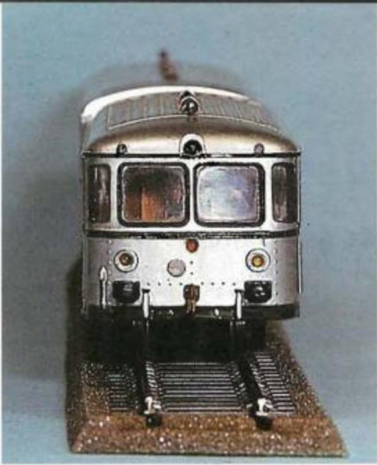
Frontal del modelo en escala H0. Pueden apreciarse las siluetas del maquinista y ayudante, y aunque apagados, los diodos amarillos de las luces de situación y faro, y los tres rojos de señalización trasera que se cambian con la marcha.
