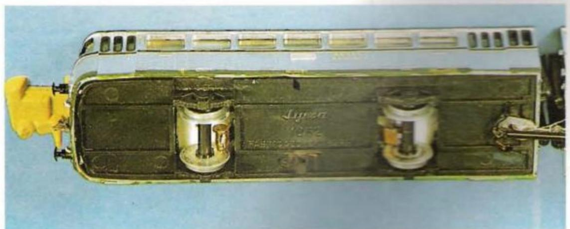
Aquí puede verse perfectamente el frotador-contacts interior de la llanta, que en este caso es un portaescobillas desechado de un motor averiado. Pero igual efectividad se logra con los hechos según el dibujo.
