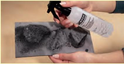
Die Fels-Gussform wird mit einem Trennmittel aus Wasser und Spülmittel eingesprüht.
