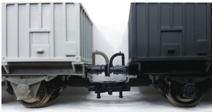
Nuevos bastidores con mejoras en el rodaje y en la cinemática de enganche corto, que permite la circulación tope contra tope con funcionalidad de los mismos cuando se utilizan con cabezas intercambiables de enganche corto de diversas marcas.
