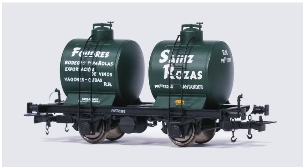
**45103** - Vagón cisterna bicuba con freno de vacío y cajas de grasa Athermos RN-20. FUDRES SAINZ ROZAS. RENFE. Compensación por balanceo en uno de sus ejes.
