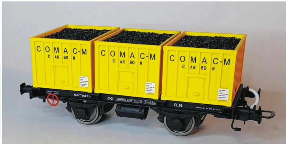
**45207** - Vagón portacontenedores COMAC con volante de freno, freno de vacío y cajas de grasa Athermos RN-21. RENFE. MC fv 152.214
