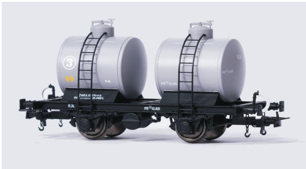
**45104** - Vagón cisterna bicuba con freno de vacío y cajas de grasa
