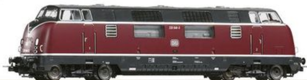
59714 Diesellok BR 220.0 DB Ep. IV, Drehgestelle mit Blattfederung
