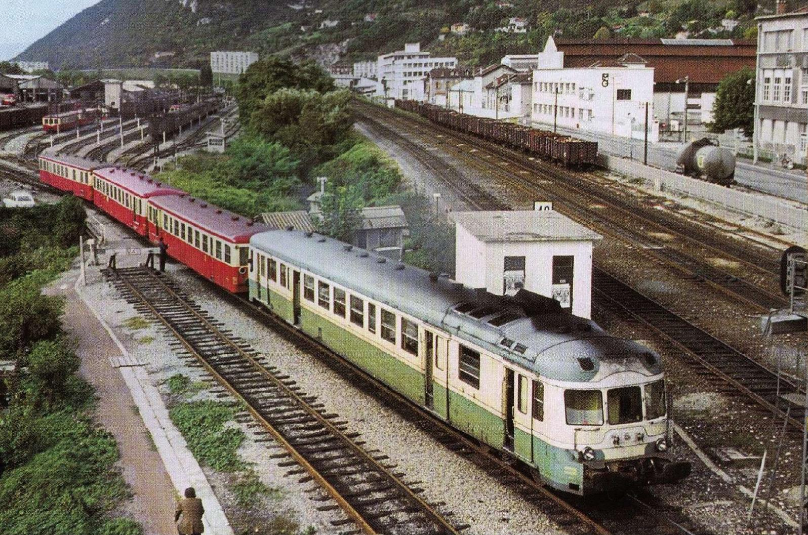
Les autorails X-2800 sont également appelés U-825 (unifié 825 ch). C'est le plus puissant des autorails monocaisses et monomoteurs français lors de sa mise en service. Spécialement conçus pour la traction de plusieurs remorques sur des lignes à profil difficile leur robustesse et leur longévité furent exemplaires. Ils ont été en service de 1957 à 2009.
