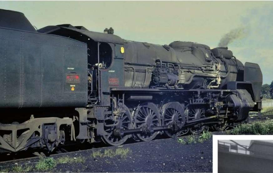
Mises au point par l'ingénieur Marc DE CASO, les locomotives 150 B et P du Nord ont beaucoup d'éléments en commun avec les 231 C « Super Pacific » notamment le foyer, la chaudière, la boîte à fumée et la cabine de conduite.
