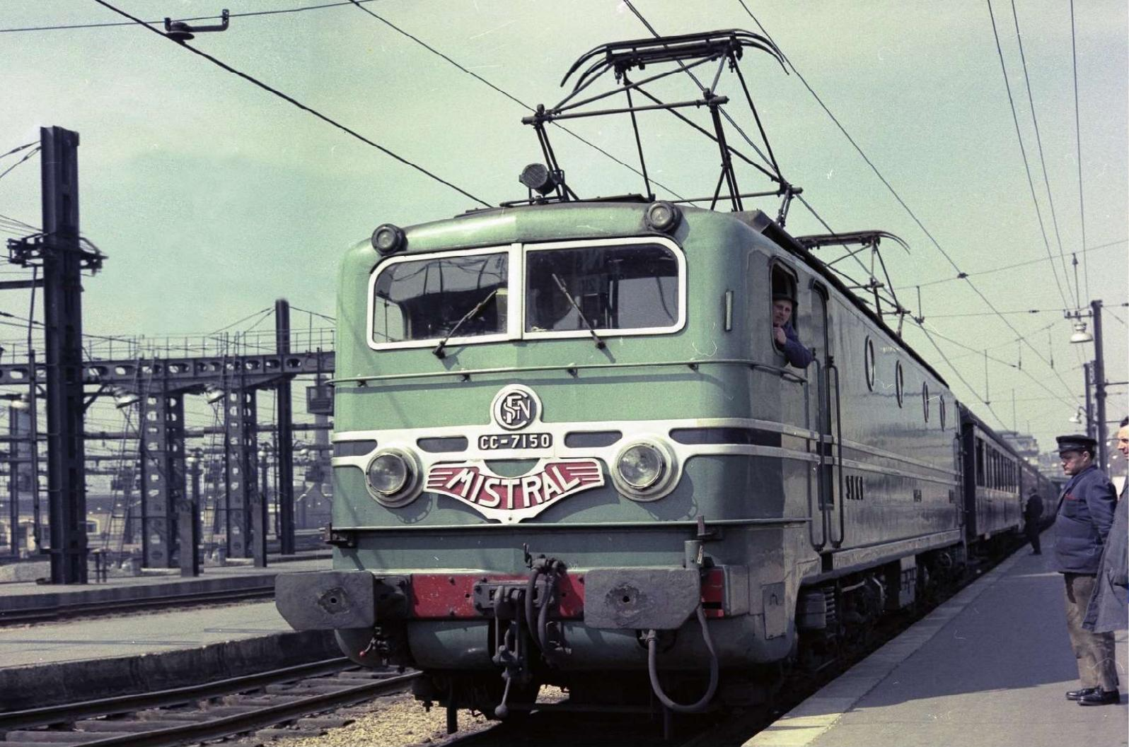
Fabriquées à 58 exemplaires de 1949 à 1955, les CC-7100 sont les premières locomotives électriques universelles à courant continu construites par ALSTHOM. Elles sont issues de prototypes qui expérimentaient le principe de l'adhérence totale pour les locomotives de puissance. Elles ont par deux fois battu le record du monde de vitesse sur rail. C'est au dépôt d'Avignon que les quatre dernières CC-7100 ont été retirées du service en 2001.
