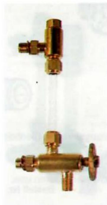
Wasserstand mit Entlüftungshahn 5 Speichen Handrad aus Messingfeinguß. Anschlußgewinde mit 2 Kontermuttern M6x0,75
