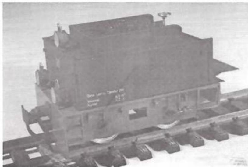
Der Tender ist ganz aus Messing gefertigt. Die Abdeckung mit aufgeklebter Kohle kann abgenommen werden. Darunter ist genügend Platz für Beleuchtungsakkus oder Rc-Anlagenteile. Die Räder sind isoliert, müssen aber noch lackiert werden. Alle anderen Teile sind lackiert und beschriftet.
