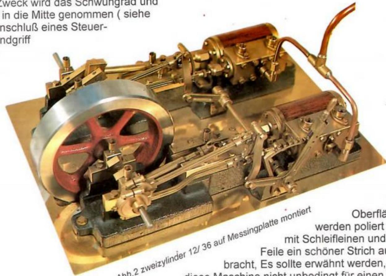
Abb.2 zweizylinder 12/36 auf Messingplatte montiert
