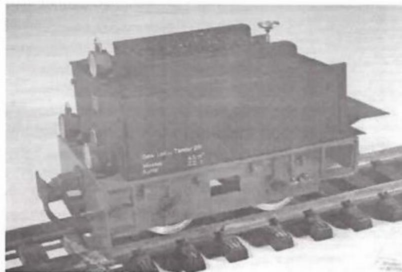
Der Tender ist ganz aus Messing gefertigt. Die Abdeckung mit aufgeklebter Kohle kann abgenommen werden. Darunter ist genügend Platz für Beleuchtungsakkus oder Rc-Anlagenteile. Die Räder sind isoliert, müssen jedoch noch lackiert werden. Alle anderen Teile sind schon lackiert und beschriftet.
