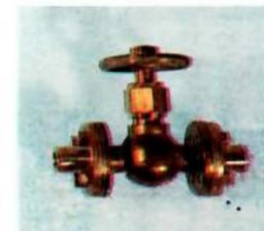
Dampfventil mit geradem Dampfdurchgang mit Flanschen Ø 16mm für Kupferrohr Ø 4mm mit 8 Schrauben M2x4 SW 3 5 Speichen Handrad aus Messingfeinguß
