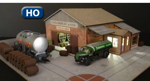
PRO 025 Chais raccordés (type 1). Socle = 285 mm x 270 mm. Bâtiment en briques anciennes creuses. 8 foudres, 9 barriques isolées, 9 empilements de 11 barriques et 6 palettes de bouteilles vides. 9 fûts et 2 empilements de 13 fûts, en résine à peindre. Éclairage intérieur par LED.
