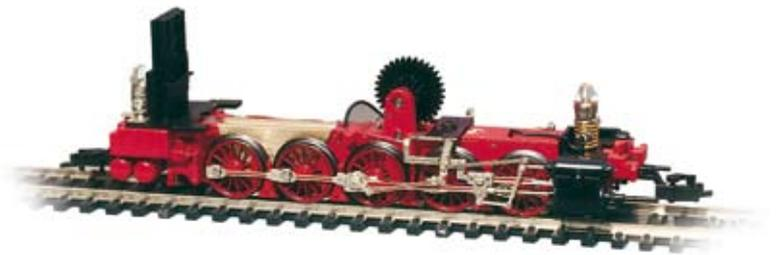
3. Am Motorausschnitt im Lokrahmen die Farbe entfernen, Klebstelle säubern und Füllstück waagrecht einkleben. Nach Abbinden des Klebers Verbindungsstelle mit feiner Flachfeile nachbearbeiten und gesamtes Fahrgestell gut säubern (sehr wirkungsvoll z.B. mit einer Druckluftdose). Dann untere Fahrgestellplatte abschrauben, neue, genügend lange Zuleitung (+) anlöten und nach oben durchziehen; Platte wieder anschrauben.
