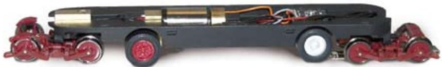
Wir bieten für den Brekina Schi-Stra-Bus (Standmodell) eine Motorisierung zum Selbsteinbau an. Unsere Motorisierung umfasst einen Glockenankermotor mit Schwungmasse und Getriebe, Stromversorgung, Lagerung des hinteren Drehgestells, Zusatzgewicht und eine Doppelbereifung der angetriebenen Hinterachse. Die Doppelbereifung ist notwendig um einen Radius ab 450mm zu fahren.
