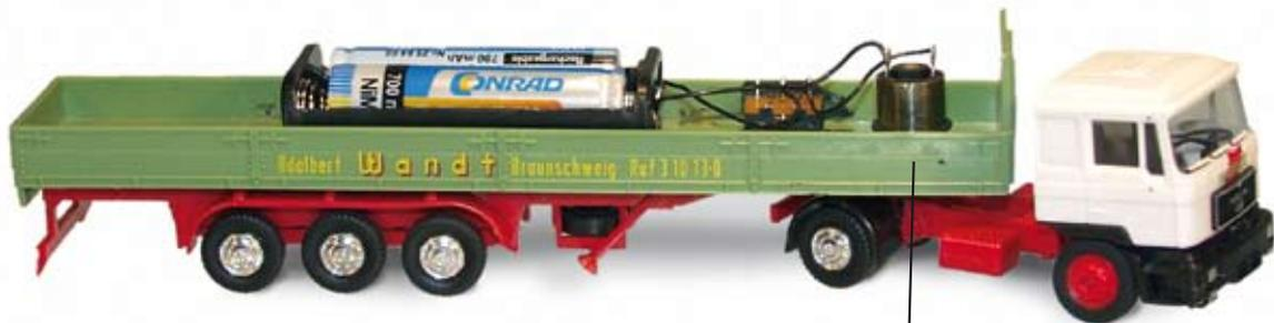
Zum Betrieb der Automodelle im Faller Car-System werden außerdem benötigt: eine lenkbare Vorderachse mit Führungsmagnet, Akkus für die Spannungsversorgung und ein Schiebeschalter. Diese Teile sind im Zubehörsatz mit der sb-Nr. 112 enthalten.
