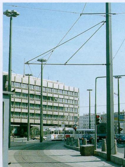
▲ Am Nürnberger Hauptbahnhof. Tragseilarme Überspannung der Bedarfs-Wendeschleife.
