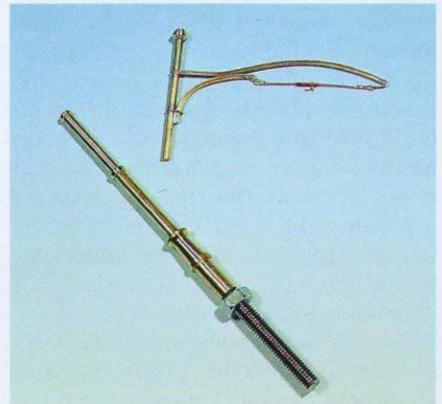
▲ Einfachmast mit separat gefertigtem Oberteil, oberer Gurt des Auslegers wie beim Vorbild mit einer Schelle am Mast befestigt. Sie ruht in einer gedrehten Nut. Das gebogene T-Profil ist nur angelötet. Auch hier gehört eine echte Schelle hin.
