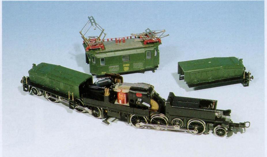
Die E 70 von Märklin, in Kooperation mit Trix entstanden: Das Innere ist fast vollständig mit Gewichten gefüllt. Der relativ kleine Motor mit Schwungmasse treibt über ein rustikal wirkendes Schneckengetriebe mit viel Spiel, aber trotzdem recht leise, das angetriebene Drehgestell. Wer den Platz für den Digital-Decoder nicht nutzen will, könnte auch das zweite Drehgestell antreiben.
