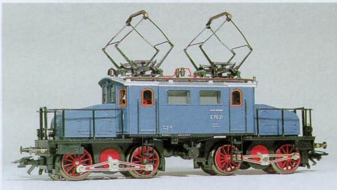
Eine Lok mit gleicher Achsfolge, aber eine ganz andere Entwurfs handschrift: Rocos E 71. Der knappe hier zur Verfügung stehende Platz ist nahezu vollständig ausgenutzt. Beide Drehgestelle sind angetrieben, der Motor ist über zwei Federn mit den Schneckengetrieben verbunden. Ein technischer Gag, der aber zweifellos große Präzision erfordert, denn die Treibräder werden tatsächlich über Blindwellen von den Kuppelstangen angetrieben.
