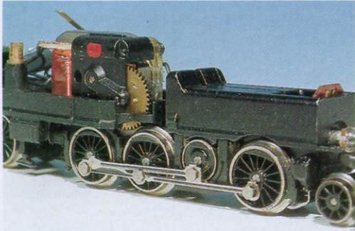
Einen ganz anderen Weg ging Märklin bei diesem älteren Modell der Schweizer Be 6/8: Nur ein Antriebsdrehgestell, das mit Getriebe und Motor eine Einheit bildet.
