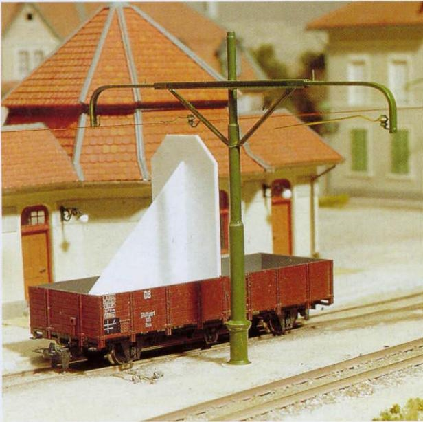
▲ Doppelmast an neuralgischer Stelle. Er ist für die Vertikalketten über den Bahnhofsgleisen bestimmt. Zugleich sorgt er für die Überspannung des Gleiswechsels und für den Beginn der Einfach-Oberleitung in der Kehrschleife. Doppelausleger aus U-Profil 1 mm x 2 mm.
