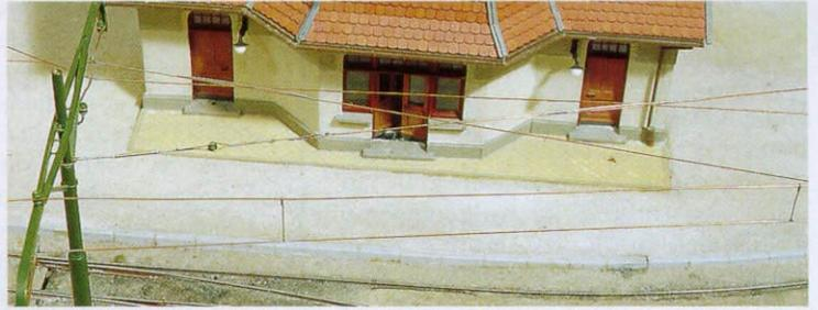
▲ Au weil Jetzt sieht's doch fast so aus wie bei einer Autoscooter-Oberleitung. Aber es geht nicht anders, denn bei 20 cm Radius, 12 mm Gesamt-Zickzack und möglichst wenig Masten mußte ein relativ langer Zusatzfahrdraht mit nur wenigen Zentimetern Pantographenkontakt eingezogen werden.
