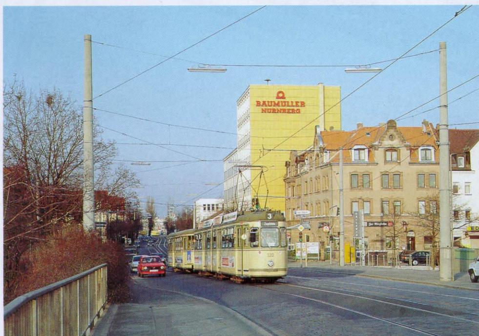
▲ Nachgespannte Straßenbahn-oberleitung an mastsparender Horizontalkette. Auch hier wieder: Nachspannung; die vier Fahrdrähte für zwei Gleise zeigen es.
