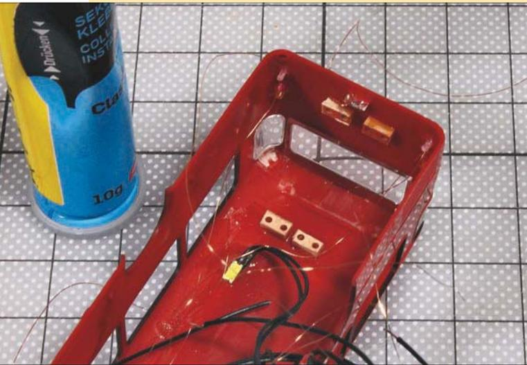
Um die dünnen Anschlusslitzen der LEDs im Inneren des Busses zu schützen, wurden kleine Löt-punkte eingeklebt. Jede separat schaltbare Lichtfunktion erhält eigene Anschlüsse.
