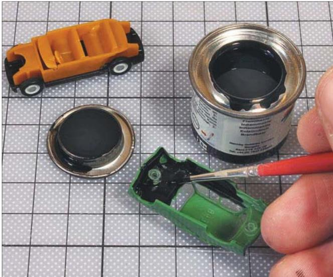
Vor dem Einbau der LEDs wurde die Pkw-Karosserie ebenso wie der Bus von innen mit schwarzer Farbe gestrichen.
