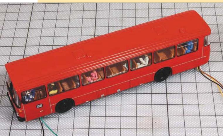
Die Leitungen werden gebündelt an zwei Stellen nach unten geführt. Vor dem Zusammenbau wurden in die Inneneinrichtung noch sitzende Figuren als Fahrgäste geklebt.
