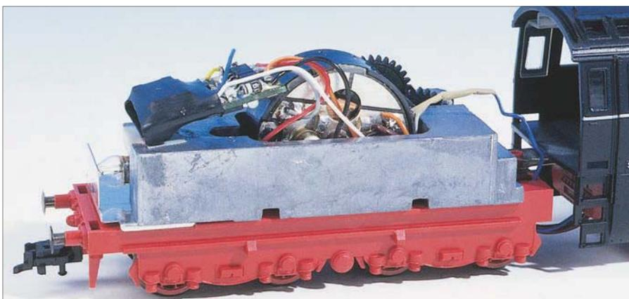
Links unsere fünf Kandidaten für einen Decodereinbau; im Bild rechts ein Einbaubeispiel für eine H0-Lok (Roco-101) mit Schnittstelle. Der Trafobehälter wartet schon auf den Decoder.
