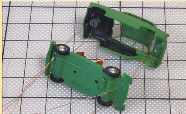
Da die Rückleuchten nur äußerlich aufgedruckt sind, wurden Löcher durch die Karosserie gebohrt und die LEDs außen angeklebt. Die Anschlusslitzen konnten danach nach unten aus dem Auto geführt werden.
