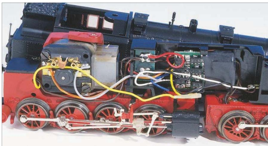
Beim „alten“ Fleischmann-Rundmotor ist besonders auf das Motorschild zu achten. Hat es Masseverbindung zu den Kohlen, wird ein neues massefreies Motorschild (als Ersatzteil) benötigt. Hier wird die Masseverbindung zur linken Schraube mithilfe eines Messers unterbrochen.
