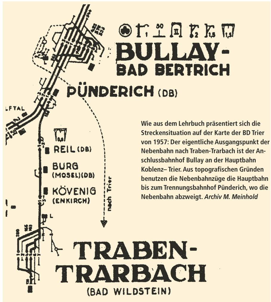
Wie aus dem Lehrbuch präsentiert sich die Streckensituation auf der Karte der BD Trier von 1957: Der eigentliche Ausgangspunkt der Nebenbahn nach Traben-Trarbach ist der Anschlussbahnhof Bullay an der Hauptbahn Koblenz–Trier. Aus topografischen Gründen benutzen die Nebenbahnzüge die Hauptbahn bis zum Trennungsbahnhof Pünderich, wo die Nebenbahn abzweigt. *Archiv M. Meinhold*
