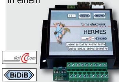
Die Kombination aus "klassischem" Gleisbelegtmelder und lokalem RailCom-Detektor vereint die schnelle Belegtmeldung mit den Detailinformationen von RailCom. HERMES' besondere Fähigkeiten: Er kann bis zu 4 verschiedene RailCom-Sender in einem Abschnitt auseinanderhalten, also z.B. Lokdecoder in Mehrfachtraktionen oder Lok- und Funktionsdecoder in einem Zugverband. Mehr Infos über HERMES → Seite 25
