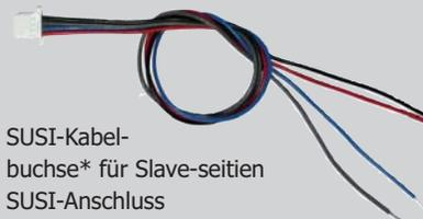
SUSI-Kabelbuchse\* für Slave-seitigen SUSI-Anschluss
