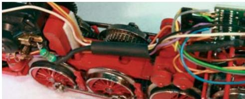
Schaltdrähte sind für den Decodereinbau denkbar ungeeignet. Auch bei geringen Querschnitten sind sie vergleichsweise steif - beim Verlegen können daher leicht die Lötspads der Decoder abgerissen werden. Da sie sich schlecht biegen lassen, kann es beim Aufsetzen des Gehäuses der Lok leicht passieren, dass sie "rausgucken". Werden die Isolierungen beim Aufsetzen des Gehäuses beschädigt, droht ein Kurzschluss - mit fatalen Folgen für den Decoder.
