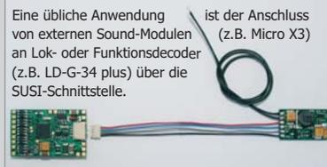
Eine übliche Anwendung ist der Anschluss von externen Sound-Modulen an Lok- oder Funktionsdecoder (z.B. LD-G-34 plus) über die SUSI-Schnittstelle. (z.B. Micro X3)
