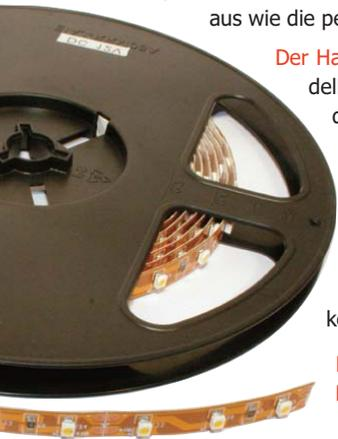
**Der Haken:** Die LED-Streifen können auf der Modellbahn nicht ohne weiteres eingesetzt werden: Sie sind für die Versorgung mit einer Gleichspannung von 12 V ausgelegt, die LEDs würden im Modellbahn-Einsatz (bei Spannungen bis 24 V) schnell durchbrennen. Außerdem fehlen auf den Streifen Gleichrichter, was die Übertragung von Digitalsignalen wegen der fehlenden Entkopplung stören würde.
