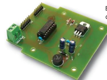
Standardmäßig wird der s88-Bus mit einer Spannung von 5 V betrieben. Daher führen bereits Störspannungen von 2,5 V zu Fehlern in der Datenübertragung. Zur Erhöhung der Versorgungsspannung des s88-Busses auf 12 V wird ein s88-Booster zwischen den Empfänger und das erste s88-Modul geschaltet. Dadurch haben Störspannungen von weniger als 6 V keinen Einfluss mehr auf die Datenübertragung im s88-Bus.
