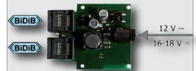
Spannungsversorgung: 12 V Wechselspannung (z.B. Steckernetzteil Art.-Nr. 70-09110-01)
