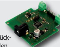
Überträgt die Rückmeldungen aus den 8 angeschlossenen Gleisabschnitten in den Tams-Rückmeldebus und ermöglicht so den Anschluss der Anzeigemodule RCA-1 und RCA-24 an den Detektor HERMES.
