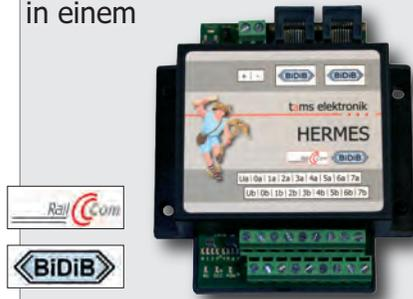
Die Kombination aus "klassischem" Gleisbelegtmelder und lokalem RailCom-Detektor vereint die schnelle Belegtmeldung mit den Detailinformationen von RailCom. HERMES' besondere Fähigkeiten: Er kann bis zu 4 verschiedene RailCom-Sender in einem Abschnitt auseinanderhalten, also z.B. Lokdecoder in Mehrfachtraktionen oder Lok- und Funktionsdecoder in einem Zugverband. Mehr Infos über HERMES → Seite 24
