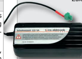
Boosteranschluss mit 4-poligem Steckverbinder
