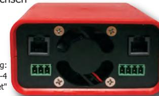
Abbildung: Rückfront Booster B-4 in der Version "LocoNet"
