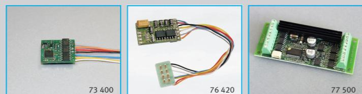
Alle Multiprotokolldecoder mit SUSI-Schnittstelle, einer 4-poligen Minibuchse, haben die Möglichkeit Soundmodule und LISSY Mini-Empfänger anzuschließen. Bei Mini-Decodern erfolgt der Anschluss über Löt pads auf der Platine.
