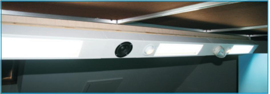
Alle Einheiten wurden aneinander gesteckt und in einer Höhe von 1 m über der Anlage in einem Winkel von 45° montiert. So werden nicht nur die Anlage sondern auch der Hintergrund optimal beleuchtet.
