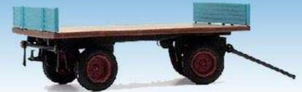
Mehrzweckanhänger mit Metallaufbau
