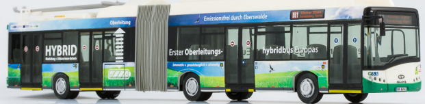
Erster Oberleitungshybridbus Europas Oberleitung + Lithium-Ionen-Batterie Solaris T18 Hybrid BBG Eberswalde 11443 , Wagen 063, 861 Kleiner Stern
