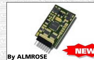
6087 Decoder funzioni per pilota Vivalto: gestione luci di marcia, terzo faro (digitale) autonomo, luce interna On/Off, regolazione luminosità luci interne e luci di marcia. Lighting decoder for Vivalto driving coach.
