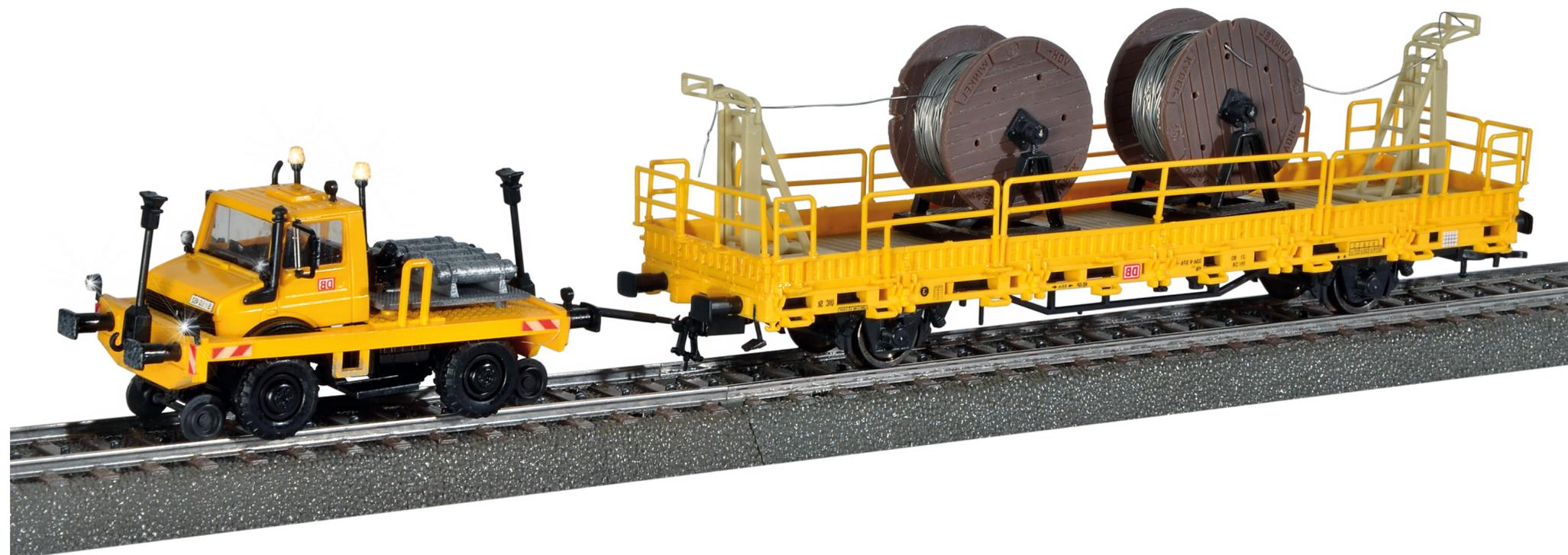
Der Unimog als Alleskönner, diesmal auf der Schiene unterwegs, zieht einen Fahrleitungsbauwagen der zur Installation von Oberleitungssystemen dient. Dabei ist die Antriebseinheit, welche dem Robel ähnlich ist, im Fahrleitungsbauwagen untergebracht.
