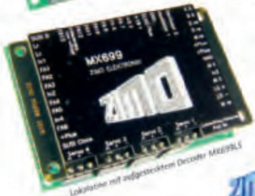
Lokplatinen mit aufgestecktem Decoder MX699LS
