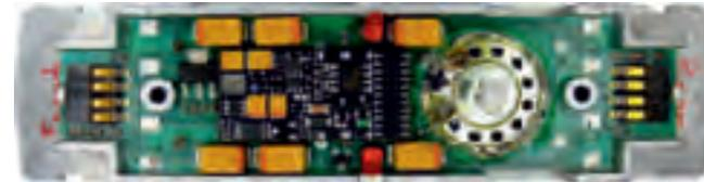
Lokplatine in einer schwedischen „Class Du“ mit aufgestecktem Sound-Decoder MX644 (MTC-Schnittstelle). Integriert auf der Platine ist ein Energiespeicher (6 Tantals, gesamt 1300 µF).
