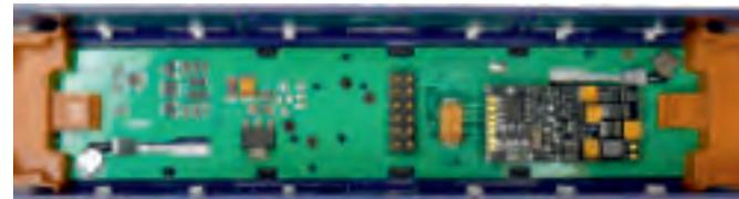
Lokplatine in der Roco E10 mit Ansteuerung der Mikro-Motoren für die Pantos; Federkontaktleiste zur Dachplatine; Sound-Decoder MX645P22.
