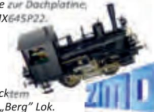
Die spezielle Lokplatine mit aufgestecktem MX648P16 für Fleischmann „Berg“ Lok.
