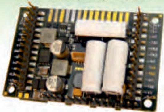
Die Stiftleisten der Großbahn-Decoder sind in Standardabführung (MX699LLS) und in Sonderausführung (MX699LLS und MX699LLV) mit 12 mm langen Stiftleisten über Sockel (16 mm über Platine).
